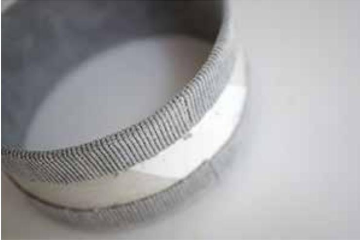
内装側面も外装と同じシリンダー形状ですが、外装・筐体とは逆の仕立てになる。落とし蓋と底面を入れるため、落とし込み幅を引いた高さで組み上げ、内側から化粧貼りし外に巻き返しをして仕上げる。
