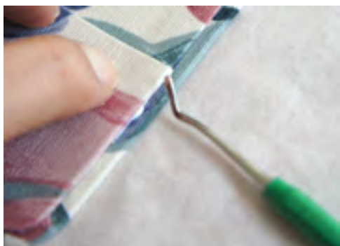
②余分な接着剤の除去 圧着して余分な接着剤をとる。
