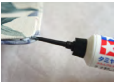
①接着剤で隙間を修正 接着不足の隙間を全て修正する。
