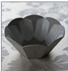
折り組み上げ式を用いた八角形カップ形状
