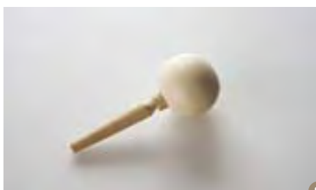
天蓋に差し込む軸をカット
